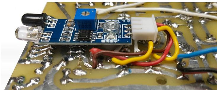
**Paso 16 – Prueba y calibración del sensor de infrarrojos**
