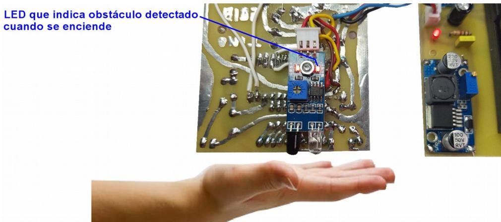
6. Con un destornillador pequeño de punta plana regular la resistencia ajustable del sensor de infrarrojos girando en sentido anti-horario hasta que llegue al extremo izquierdo.
